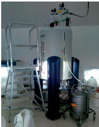
**Slika 4:** Fotografija Ultrashield Advance III Bruker spektrometra s 500 MHz superprevodnim magnetom.
