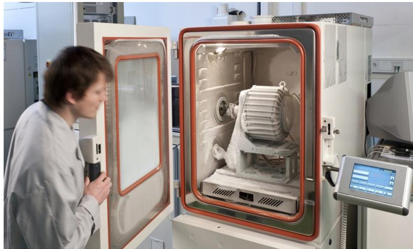
Slika 5. Testiranje EC motorja za prezračevalne sisteme v klimatski komori pri -40°C.
