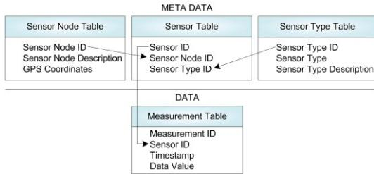
**Figure 1:** Database schema
