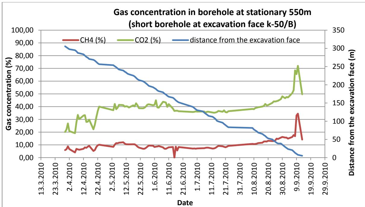
Slika 2-2: Rezultati spremljave koncentracij premogovnih plinov v horizontalni vrtini na območju Jame Pesje (k. -50/B)
