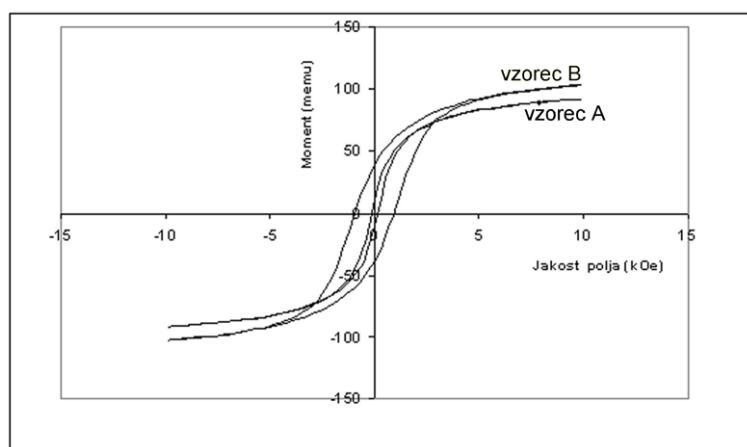
**Slika 4:** Magnetna histereza merjena pri sobni temperaturi za nanosa pripravljena iz vzorcev A in B.
