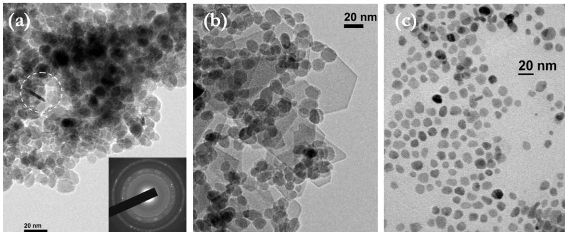
Slika 1: TEM posnetek delcev Ba heksaferita sintetiziranih pri temperaturi 150 °C (M-150) (a), pri temperaturi 180 °C (M-200) (b) in pri temperaturi 200 °C v prisotnosti oleinske kisline (OA-200) (c). Delci Ba heksaferita na sliki (c) so bili na TEM mrežico nanešeni v obliki stabilne suspenzije v dekanu.
