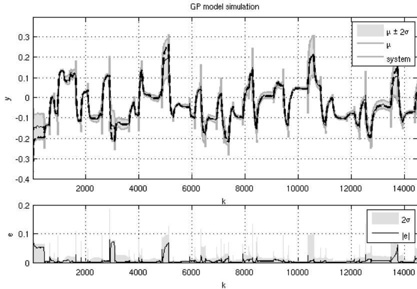
**Slika 2:** Rezultat simulacije in primerjava s testno množico meritev (zgornja slika) in prikaz napake s pasom zaupanja v napoved za rezultate simulacije (spodnja slika)
