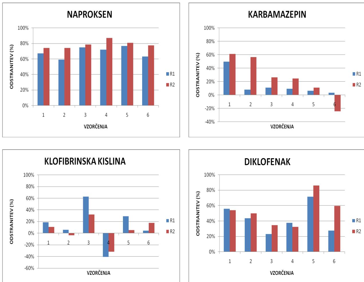
**Slika 2:** Rezultati odstranitve (%) izbranih zdravilnih učinkovin v pilotnih bioreaktorjih
