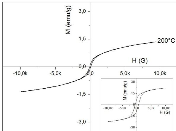
Slika 2: Magnetne histereze za vzorce Ba heksaferita sintetizirane pri temepraturi  $200\text{ }^{\circ}\text{C}$  (OA-200) v prisotnosti oleinske kisline in Ba heksaferitni nanodelci sintetizirani pri  $160\text{ }^{\circ}\text{C}$  (M-180) brez dodatka surfaktanta (vstavljen v sliko).
