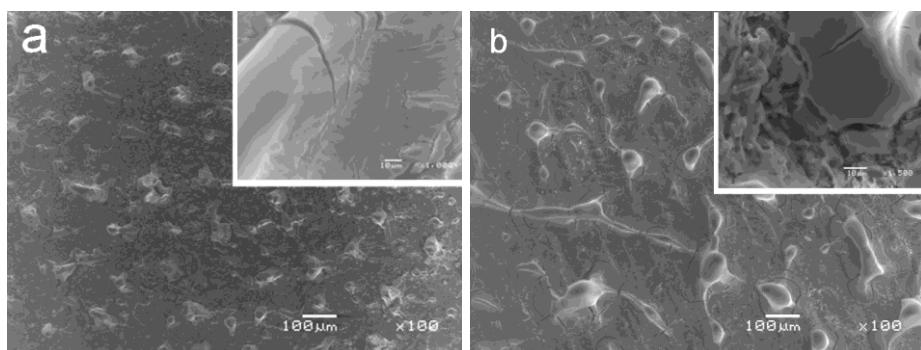
**Slika 3:** SEM slika stolpičastih struktur  $\text{CoFe}_2\text{O}_4$  (glezano od zgoraj), vzorec A (a) in vzorec B (b). Povečana izseka prikazujeta pogled od strani.
