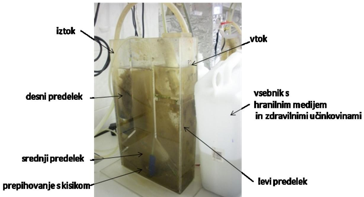
Slika 1: Pilotni bioreaktor
