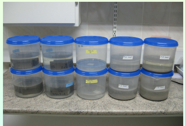
A - Zdrobljen cementni kompozit v slani vodi
