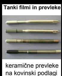
EPD je dvostopenjski proces. V tekočini dispergirani električno nabiti delci se pod vplivom električnega polja **1) gibljejo proti nasprotno nabiti elektrodi in 2) se naložijo na elektrodo**. Na elektrodi nastaja relativno gost in homogen depozit, ki ga je praviloma treba še ustrezno termično obdelati.
