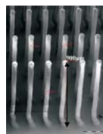
Natisnjeni piezoelektrični mikrostolpci (Lejeune et al., J. Eur. Ceram. Soc. , 2009).
