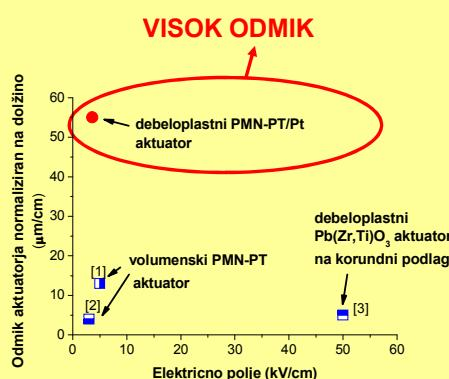
Slika 4: Primerjava normiranega odmika PMN-PT/Pt aktuatorja ter normiranih odmikov aktuatorjev iz literatur:
