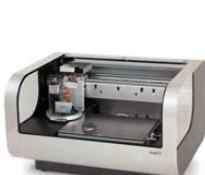
Ink-jet tiskalnik Dimatix ([www.dimatix.com](http://www.dimatix.com))
